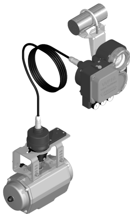
Figura 2.16 – Montagem do sensor remoto do VVP10.
